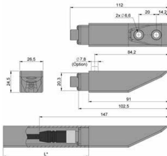
L\* - Die Länge des Kamerafortsatzes ist abhängig von der Länge des Gabelzinken.
